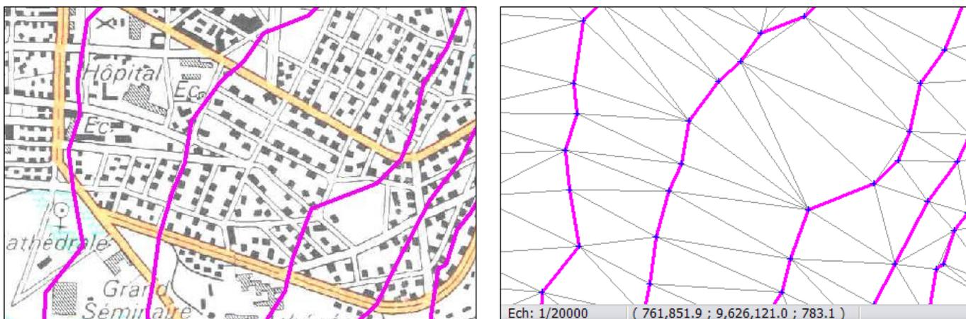
Le MNT est alors construit dans RESODO en quelques secondes : il est visible dans la figure à droite, qui affiche aussi l'altitude au droit du curseur (altitude 783.1 m, curseur non visible ici).
