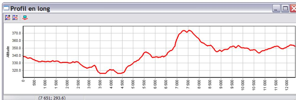
Le profil en long ci-contre a été construit en traçant une simple polygone puis en récupérant les altitudes du MNT le long de la polygone.
