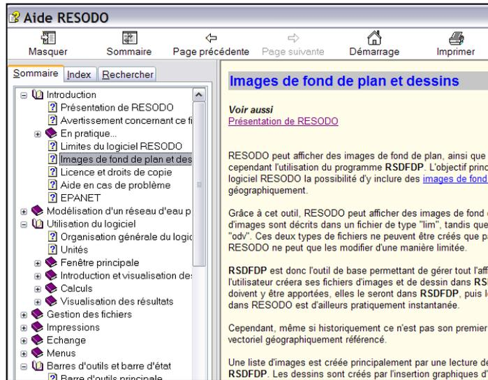
Lorsque l'utilisateur presse la touche F1 du clavier, RESODO charge automatiquement l'aide concernant le sujet qui est actif à l'écran, qu'il s'agisse de la fenêtre principale, d'une fenêtre secondaire, d'un menu, ou encore d'un dialogue.
